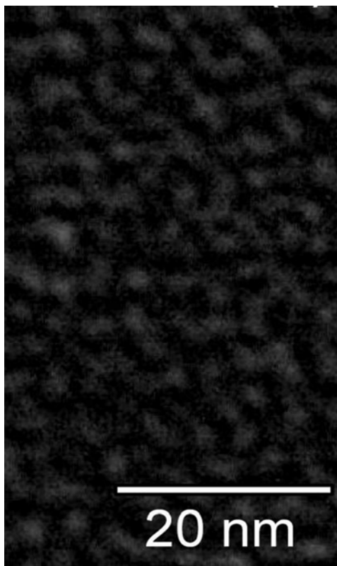
Σχήμα 1.9.7: Μικρογράφημα TEM του μεταλλοπολυμερούς D3 . Η απόσταση μεταξύ των γειτονικών κιονοειδών δομών υπολογίστηκε στα 3.6nm.
